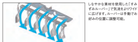
しなやかな素材を使用した「すみずみルーバー」で airflow をよりワイドに広げます。ルーバーは手動でお好みの位置に調整可能。
