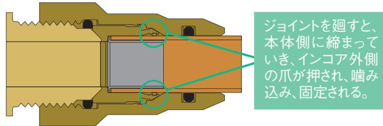
スリーブの爪部が配管に食い込むことで、抜けにくく、ガス漏れしにくい安心の構造。
