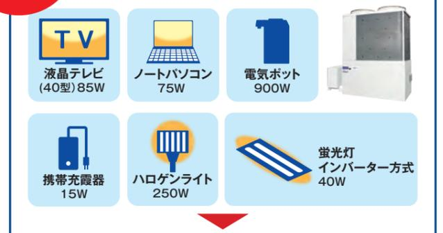
3kVAでは照明 インバーター方式 約37台分 または TV 液晶テレビ 約35台分 または 携帯電話の充電 約200台分
