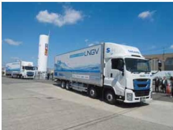
▲LNGステーションと大型LNGトラック
