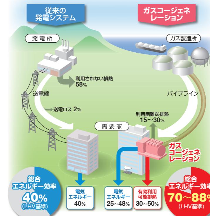
ガスコーチェネレーションは、1次エネルギーである天然ガスを燃料とし、使う場所で電気を作る「分散型発電システム」です。発電に伴って発生する排熱を有効利用することにより、**70~88%**の高い総合エネルギー効率を実現し、省エネルギーに貢献します。
